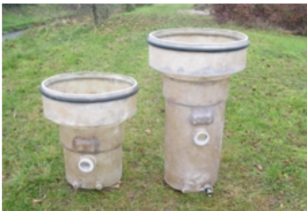
Kurzer Sommerschacht oder tiefer Schacht für Winterbetrieb.
